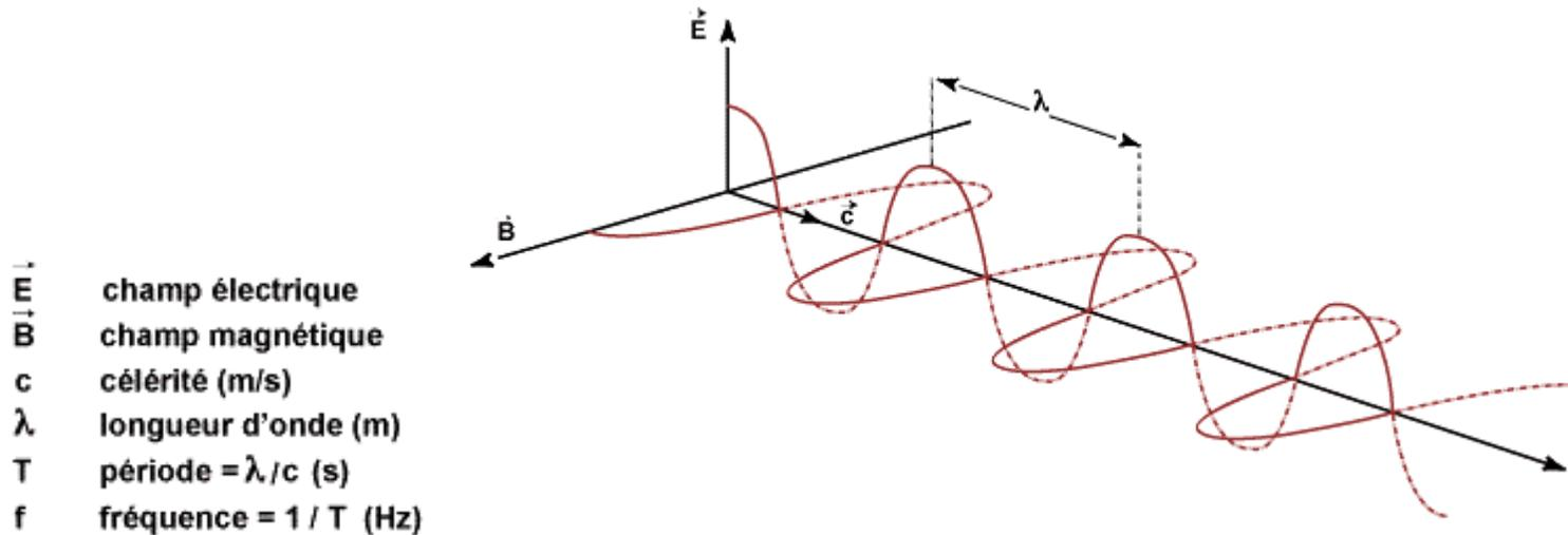
La lumière est une onde électromagnétique, de longueur d'onde  $\lambda$ , qui se propage dans un milieu transparent et isolant (diélectrique).
